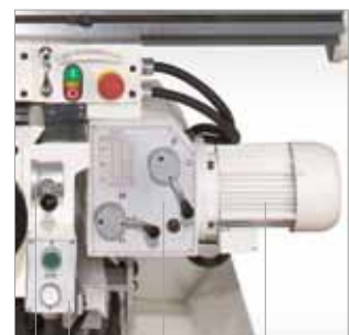
UFM 125 Spindelgetriebe mit Schnellschaltelementen
