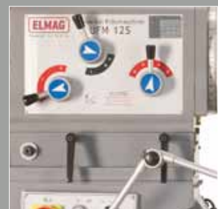
UFM 125 Spindelgetriebe mit Schnellschaltelementen
