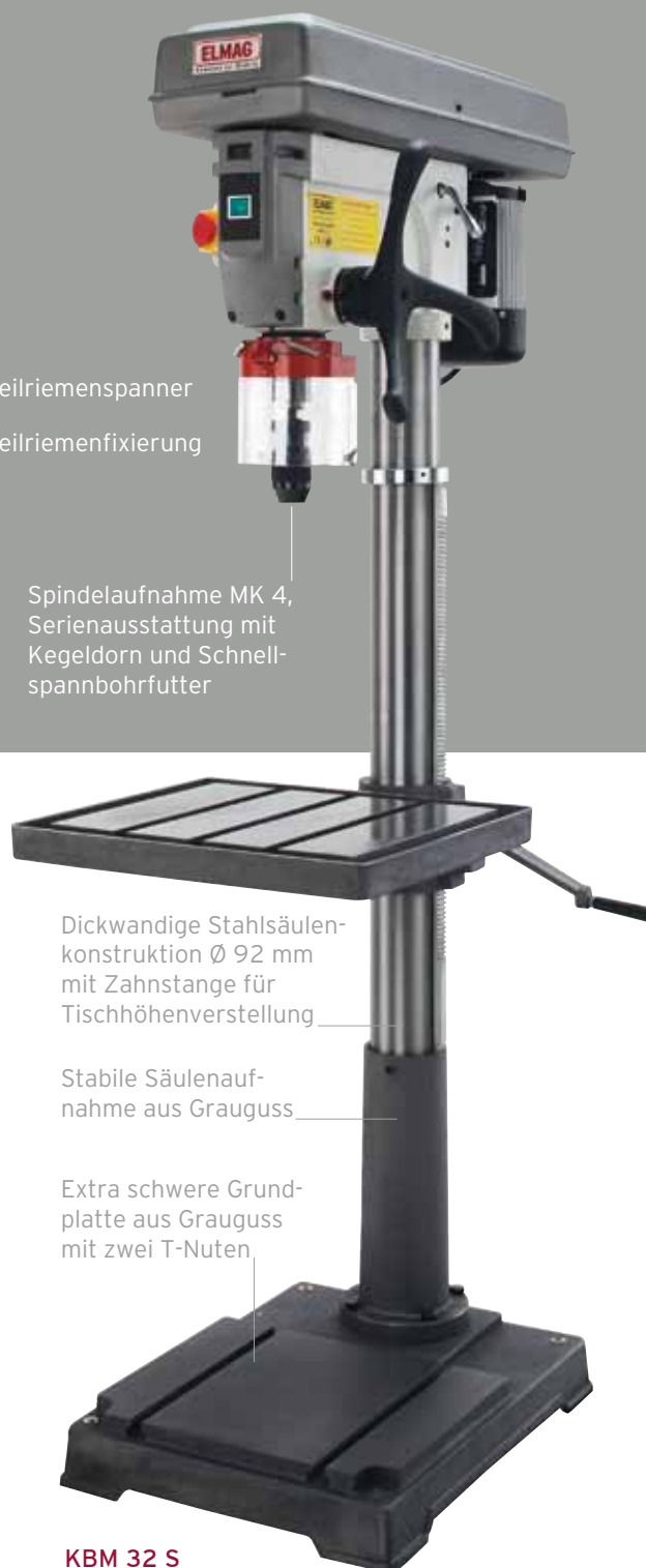
Großer, flexibel einstellbarer Bohrtisch 475 x 425 mm mit drei T-Nuten und Kühlmittelrinne
