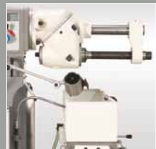
UFM 125 mit Horizontal- spindel für einfachen Umbau zu Horizontalfräse
