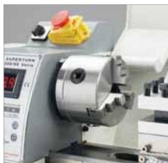
Dreibacken-Drehfutter \varnothing 100 für Außen- und Innenspannung
