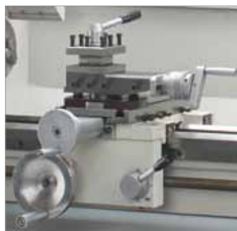
Werkzeugschlitten mit nachstellbaren Führungsleisten
