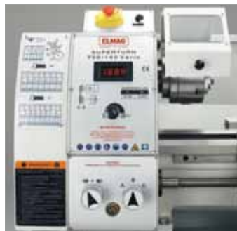
Drehzahlregelung mit Digitalanzeige, Getriebschaltung
