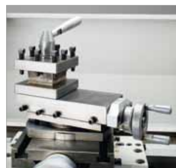
Drehbarer Oberschlitten für das Kegeldrehen
