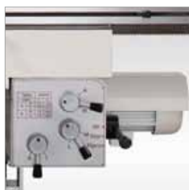
Kreuztisch-Vorschubgetriebe mit Eilgang
