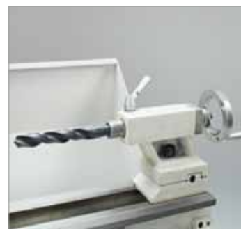
Reitstock Pinolenkegel MK 2, Pinolenweg 70 mm
