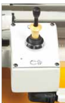
R/L-Steuereinheit für Ansteuerung des Drehschindel-Rechts- oder Linkslaufs
