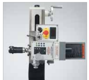
Fräskopfposition für vertikales Planfräsen
