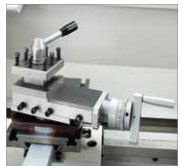
Drehbarer Oberschlitten für das Kegeldrehen
