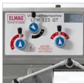
UFM 125 GT mit Vertikal- und Horizontalspindelgetriebe, leichtgängige Schnellschaltelemente
