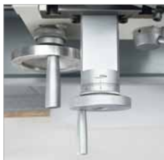
Gut ablesbare Skalenringe, Skalenteilung 0,05 mm
