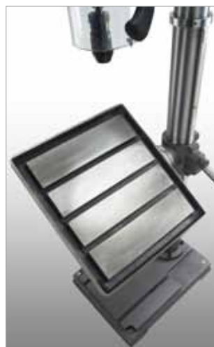
Großer, flexibel einstellbarer Bohrtisch 475 x 425 mm mit drei T-Nuten und Kühlmittelrinne
