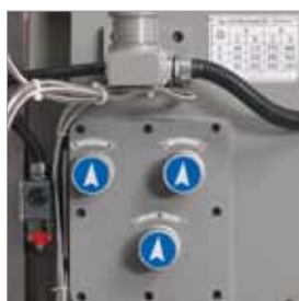
UFM 125 GT mit Vertikal- und Horizontalspindelgetriebe, leichtgängige Schnellschaltelemente
