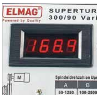
Optimal: Digitale, gut ablesbare Drehzahlanzeige
