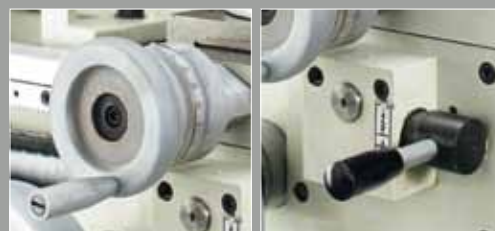
Einstellbare Feinskalen Längs-/Quervorschub
