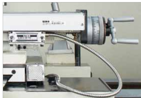
Oberschlitten mit Ableseeinheit auf einer Universaldrehmaschine
