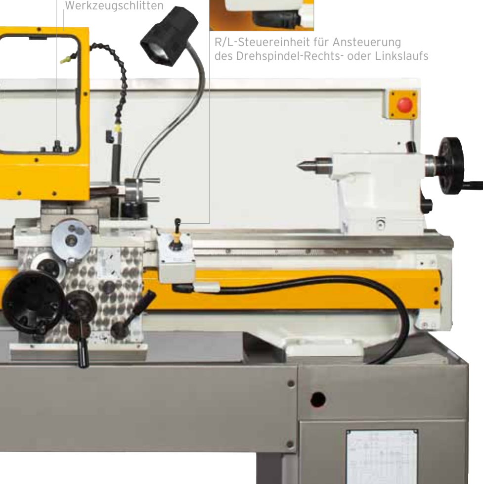
Spritzschutz am Werkzeugschlitten
