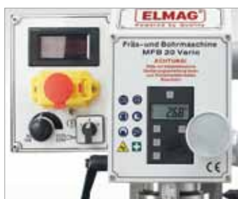
Stufenlose Drehzahlregelung mit Digitalanzeige, Rechts-/ Linkslaufschalter, digitale Bohrtiefenanzeige, Mikrovorschub
