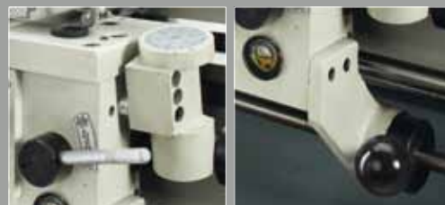
Leitspindel Schlossmutter / Gewindeuhr Schlosskasten Ölstand / Drehspindel LI / O / RE
