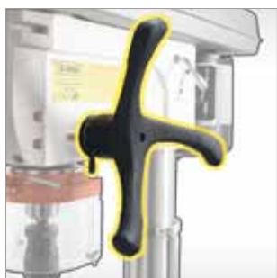
Gusshandrad für gutes Handling und optimale Kraftübertragung
