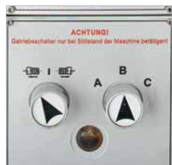
Getriebebeschaltung für Vorschubumkehr und Vorschubstufen
