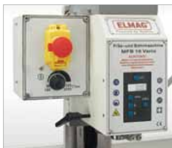
Stufenlose Drehzahlregelung, digitale Bohrtiefenanzeige
