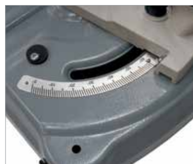
Gut ablesbare Winkelskala - einfache Geh-rungseinstellung 0 bis 60°
