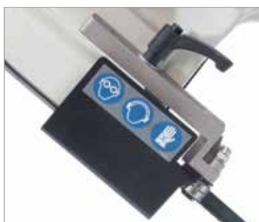
Lösen und Verstellen der Spann-lager mit einer Hebeldrehung
